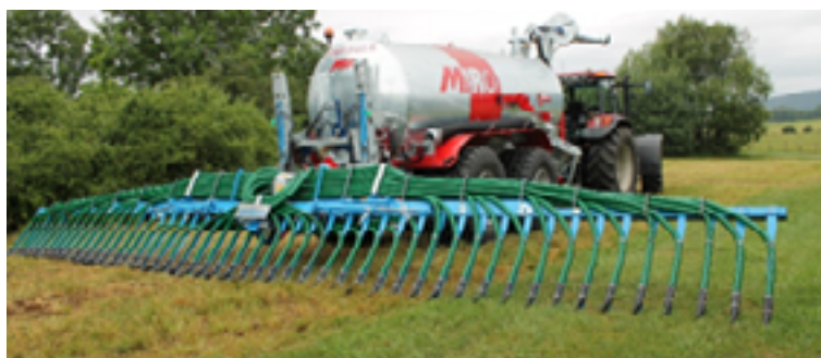
PHOTO 9/ Rampes à patins
