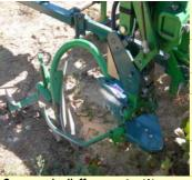
Commande d'effacement : tâteur rigide pilotant un distributeur pneumatique, vérin pneumatique double effet
